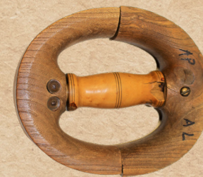
Craveira de madeira. 1931 Aparelho utilizado para alargar a copa do chapéu. Coleção Museu Municipal de Vila Franca de Xira Wooden enlarger. 1931 Device used to extend the hat crown. Vila Franca de Xira Municipal Museum Collection
