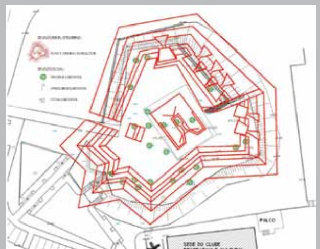
Fig. 10 - Sobreposição aproximada da planta do Forte nº 385 (a vermelho) com o levantamento topográfico no ano de 2008 (GOMES, F.)
